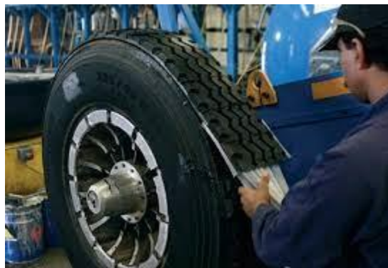
شکل ۳۸. نصب ترد در روکش سرد
